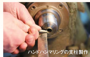
ハンドハンマリングの支柱製作
